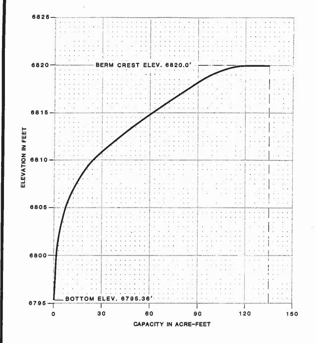
VOLUME-ELEVATION CURVE N2-RC
